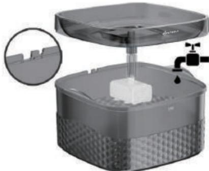
2. Connectez la pompe installée au couvercle de stockage de l'eau;
