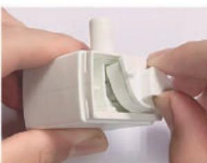
2. Den deckel der pumpe entfernen;
