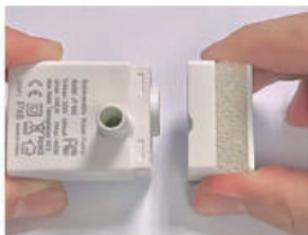
1. Den deckel einer wasserpumpe entfernen;
