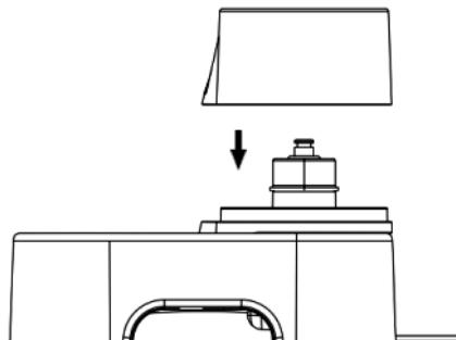
6. Platzieren Sie die Wasserauslassplattform T auf die Wasserauslassplattform M.
