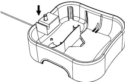
2. Platzieren Sie die kabellose Wasserpumpe an der entsprechenden Stelle in der Wasserauslassplattform, achten Sie darauf, dass die Richtung der Pumpe mit dem Schema übereinstimmt.
