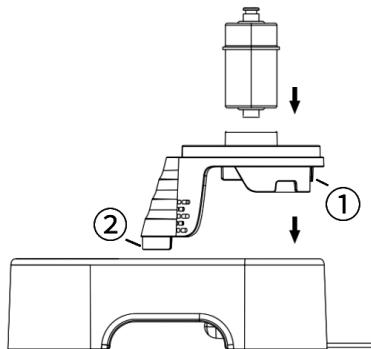
4. Placez le bol d'eau B sur le bac d'eau G. Enclenchez d'abord le loquet 1, puis le loquet 2. Enfin, insérez le filtre à eau d'ultrafiltration dans le bol d'eau en forme de B.
