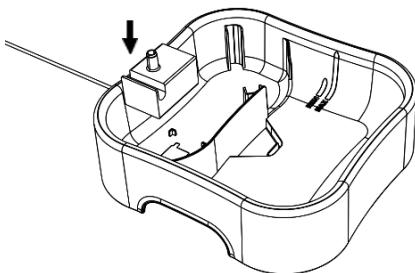
2. Coloque la bomba inalámbrica en el interior de la cuenca de agua G. Asegúrese de que la dirección sea la misma que la imagen.
