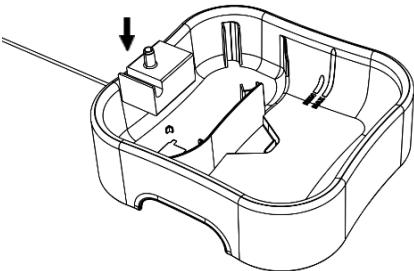
2. Положите беспроводной водяной насос в соответствующее место внутри водяного стола, обратите внимание на то, чтобы направление водяного насоса соответствовало схеме.
