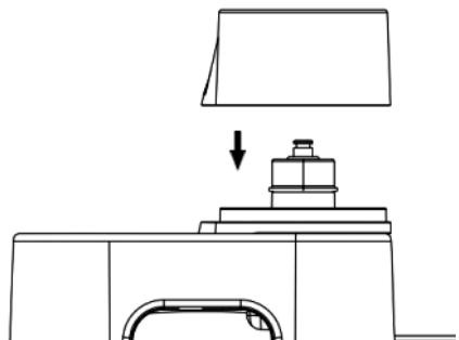
6. Placez le bol d'eau en forme de T sur le bol d'eau en forme de M.
