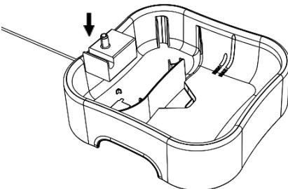
2. Placez la pompe à eau sans fil à l'endroit correspondant dans la bac à eau, et en veillant à ce que la direction de la pompe soit conforme au schéma.
