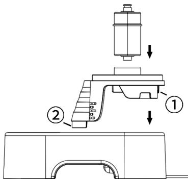
4. Legen Sie den Wasserauslassplattform B auf das Gehäuse. Lassen Sie den Verschluss zuerst bei 1 und dann bei 2 einrasten.; Setzen Sie dann den Ultrafiltrationsfilter ein.
