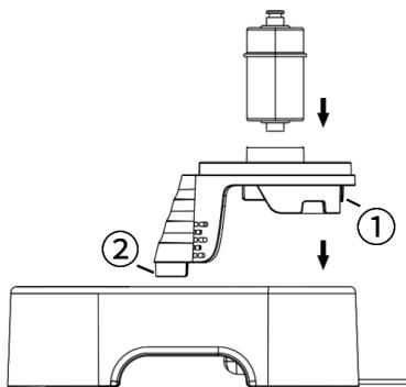
4. Coloque cuenca B por encima de cuenca G, se pueden usar dos hebillas para la fijación, luego inserte el elemento de ultrafiltración en la cuenca B.
