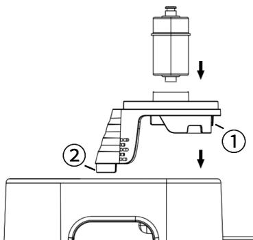
4. Положите водовыпускной стол В на нижний корпус. Сначала защелкните застежку на месте 1, затем на месте 2.; Затем вставьте ультрафильтрационный фильтр.
